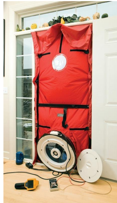
Blower Door Test
